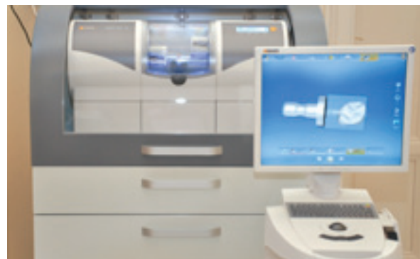
Fig 11. Unitatea de achiziție CEREC AC și unitatea de frezare CEREC MC XL (Caz CEREC 5759)
